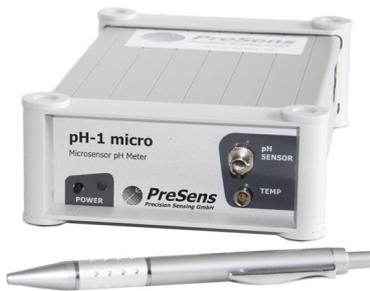
Das pH-1 micro ist ein präzises faseroptisches pH-Meter. Es ist temperaturkompensiert und wird mit pH Mikrosensoren verwendet, die auf einer 140 µm Glasfaser basieren. Ein PC ist angeschlossen, um die benutzerfreundliche Software zu betreiben. Zusätzlich hat das pH-1 micro einen analogen Ausgang und einen Trigger-Eingang.
