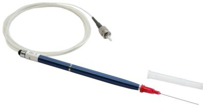
Der pH Profiling-Mikrosensor kann für alle Profilinganwendungen in halbfesten Substanzen wie Sedimenten, mikrobiellen Matten oder Biofilmen eingesetzt werden. Der PM-HP5 ist die robusteste Version der PreSens pH Mikrosensoren und verfügt über eine eng anliegende Faserführung und mechanische Verriegelung für eine präzise vertikale Lokalisierung der Messspitze. Die Sensorspitze ist über einen Drehmechanismus ausfahrbar.
