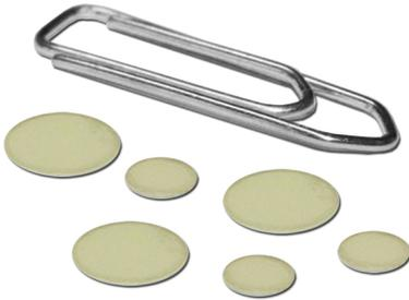
Die CO<sub>2</sub> Sensorspots messen den Partialdruck von gelöstem Kohlendioxid. Die Spots werden auf der Innenseite von Glas- oder transparenten Kunststoffgefäßen befestigt. Die Messungen werden dann von außen berührungslos durch das transparente Behältermaterial vorgenommen.
