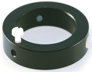
Der Vial Adapter wird verwendet, um die optische Polymerfaser (POF) mit Hilfe einer Schraube an einem 20 ml SensorVial (Schraubdeckelgläschen mit integriertem Sauerstoffsensorstreifen) zu befestigen. Er kann in verschiedenen Höhen am Schraubdeckelgläschen angebracht werden, um in der flüssigen Phase und auch im Kopfraum zu messen. Der Vial Adapter kann auch im Wasserbad eingesetzt werden. Die POF ist als separater Zubehörartikel erhältlich.
