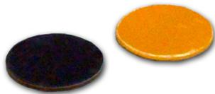
Dieser O<sub>2</sub> Sensorspot kann in das transparente Gefäß des Kunden integriert werden, und wird dann berührungslos mit dem SDR SensorDish® Reader ausgelesen. Der SP-PSt5 ist vorkalibriert. Er hat eine optische Isolationsschicht, die den sauerstoffempfindlichen Farbstoff abschirmt, so dass dieser Sensor bei Umgebungslicht und sogar bei Beleuchtung eingesetzt werden kann, z. B. bei Photosynthese-Messungen. Der Sensorspot kann mit Ethanol gereinigt werden und ist somit wiederverwendbar.
