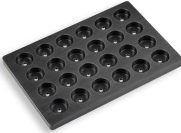
Die SDR-MSV24 schirmt die Leseroptik des SDR vor künstlichem Licht ab, so dass optische Sauerstoffmessungen nicht gestört werden. Dies ermöglicht die Verwendung von SensorVials während der Belichtung in Photosynthese-Experimenten. Darüber hinaus gewährleistet die Maske die korrekte Positionierung der SensorVials auf dem SDR. Bis zu 24 Schraubdeckelgläschen im 2 ml oder 4 ml Format können in die Maske gestellt und mit dem SDR ausgelesen werden.
